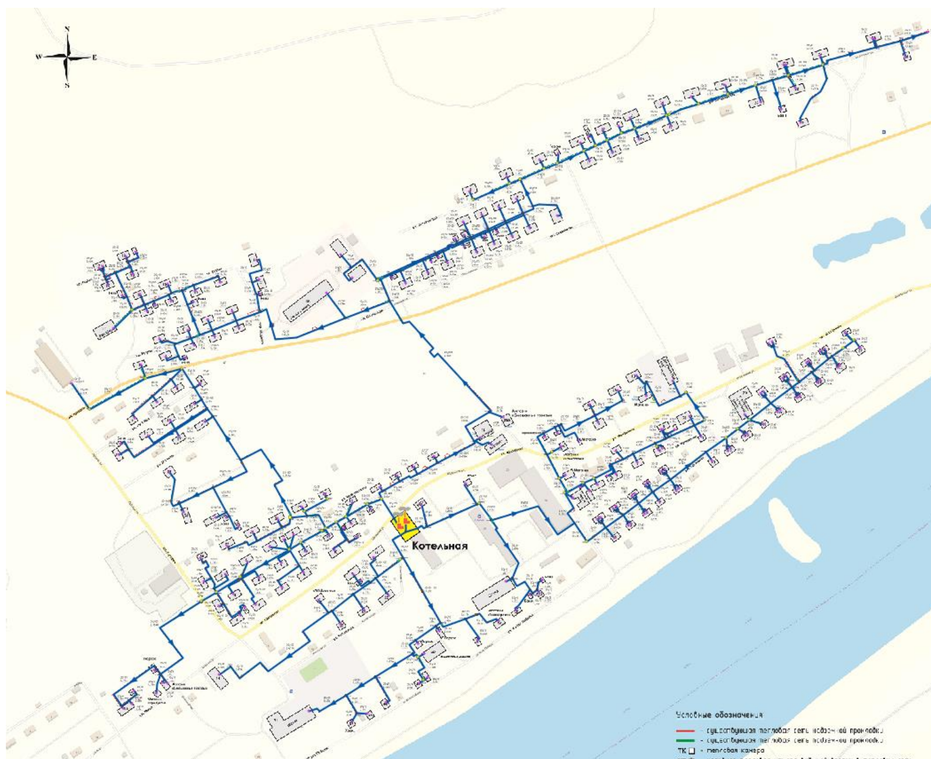
Рисунок 1.3.2.1 - Схема тепловой сети от источника тепловой энергии Котельная п. Верхнемарково
